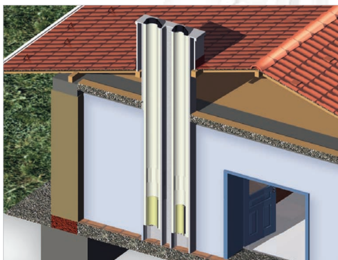
ArchiCAD-ben renderelt Absolut kéményrendszer metszeti képe:
