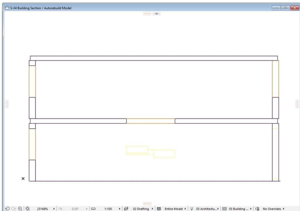
In „V-1“ Schnitte können Sie „M-1“ als Referenzzeichnung verwenden, wenn Sie Transparentpause aktivieren. Stellen Sie die Ebenenkombinationen der „M-1“ Schnitt so ein, dass Ebenen der Decken mit Drahtmodell erscheinen. In diesem Fall, wird die Decke die Betonstahlelemente nicht verdecken.
