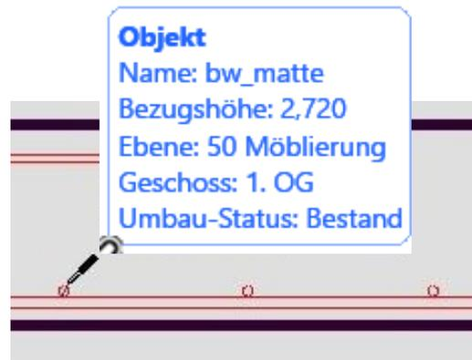
Geben Sie den „Ansicht / Zoom / Optimieren“ Kommando aus. Finden Sie das Element. Das ist nicht schwer, weil das Element mit der Etiket und dem Ansicht des Originalelements gezeigt wird. Verschieben und drehen Sie dieses Element in die entsprechende Position.
