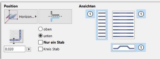
Stäbe können horizontal, vertikal oder lateral platziert werden. Diese Positionen ermöglichen, dass Stäbe auch in Stützen verwendet werden können.
