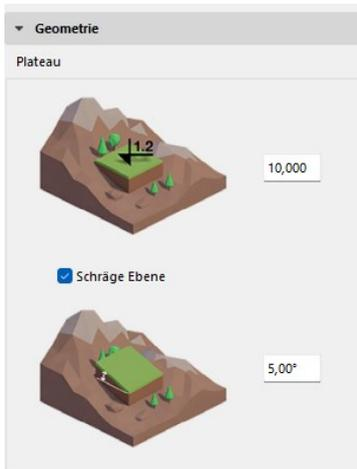
Wenn das Kontrollkästchen aktiviert ist, wird das Feld darunter aktiviert und es kann die Neigung der Ebene definiert werden. Alle anderen Felder haben die gleiche Funktion wie zuvor beschrieben, konfigurieren Sie sie nach Bedarf und klicken Sie auf die Schaltfläche OK.
