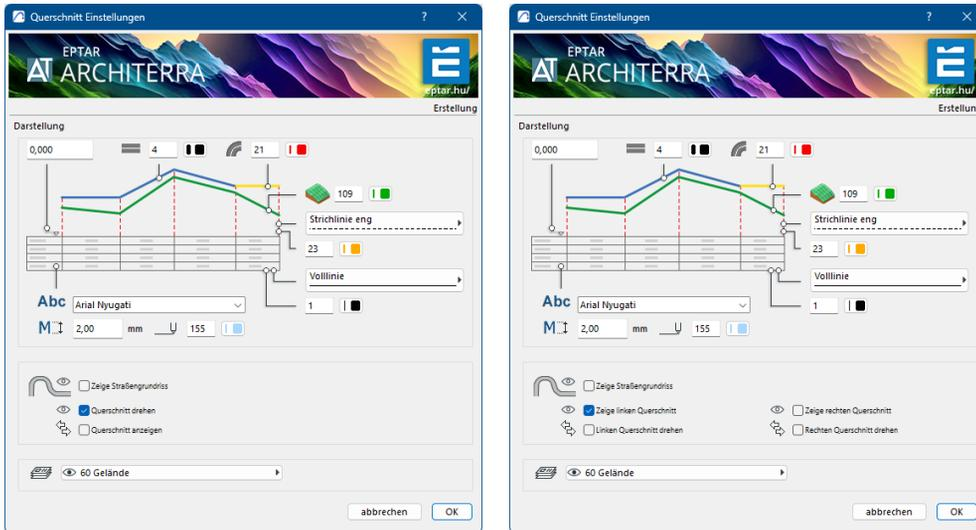
Das numerische Feld oben links ermöglicht die Einstellung der Referenzhöhen (innerhalb der Grenzen des verfügbaren Intervalls). Mit diesem Feld kann der Anwender z.B. die verschiedenen Längsschnitte ausrichten und kongruent machen.
