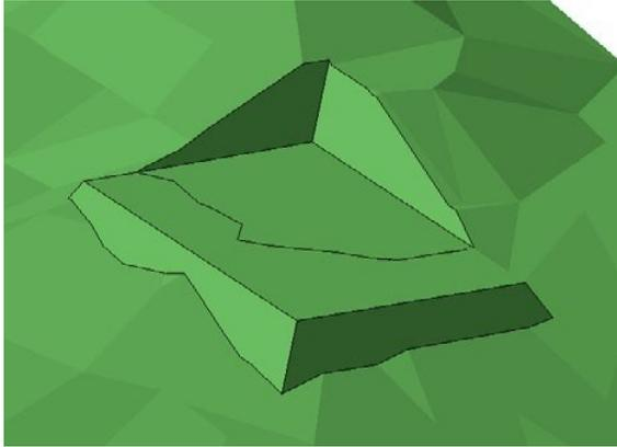
In einer späteren Phase wurde die Höhe des Plateaus modifiziert und spürbar angehoben. Wie auf dem folgenden Bild zu sehen ist, hat diese grafische Modifikation einen Block an der Basis hinterlassen, wo die ursprüngliche Länge der Steilstufe nicht mehr ausreicht:
