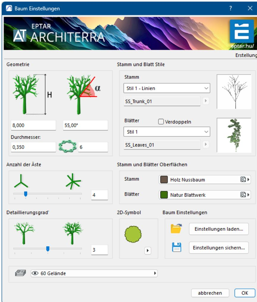
Im Abschnitt Geometrie können die Gesamthöhe des Baumes, der Winkel der Äste in Bezug auf eine imaginäre horizontale Linie (der Wert kann negativ sein, um Nadelbäume zu erzeugen), der Durchmesser des Stammes und die verwendete Auflösung definiert werden.
