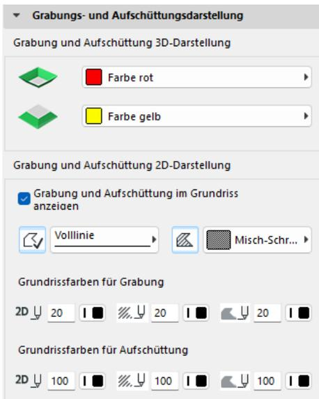
Ab Version 5 sind die Einstellungen für die 2D- und 3D-Ansicht getrennt. Benutzer können konfigurieren, ob der Umfang der Ausgrabung in der Kartenansicht angezeigt wird (durch Aktivieren des entsprechenden Kontrollkästchens links) und welche Stifte zur Darstellung des Randes der Ausgrabung in der Karten- und 3D-Ansicht verwendet werden.
