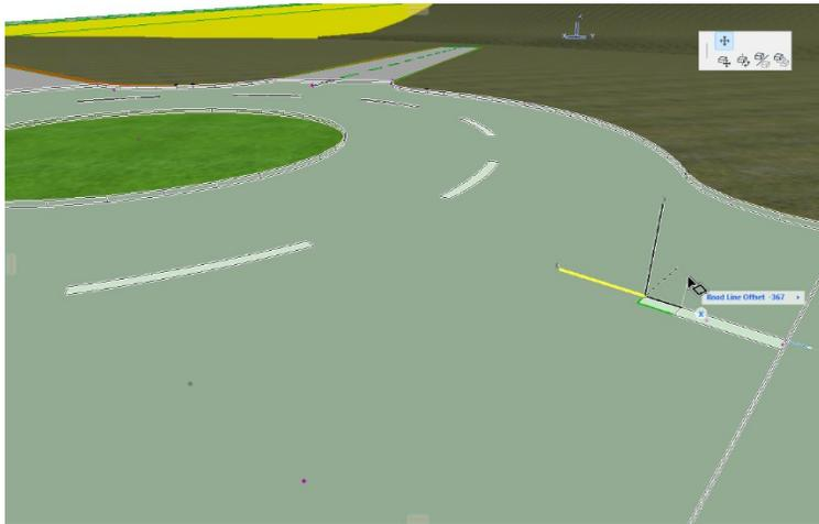
Das Straßenprofil kann im Fall von Kreuzungen angewendet werden, sodass die zusammengesetzte Struktur auch in der Schnittansicht sichtbar ist.
