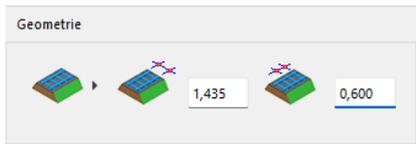
Unmittelbar darunter im Abschnitt Hangwinkel können vier Felder den Winkel der ausgehobenen und verfüllten Böschungen rechts und links der Eisenbahn definieren.
